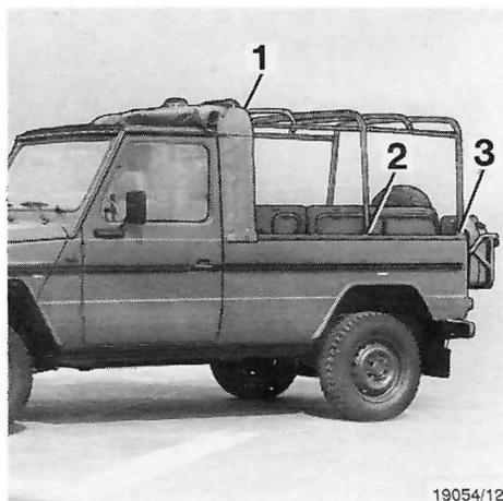
Befestigungsschraube der Querstrebe (1 links u. rechts) lösen. Klemmschellen (2 u. 3 li. u. re.) lösen und Verdeckstreben komplett abnehmen.
