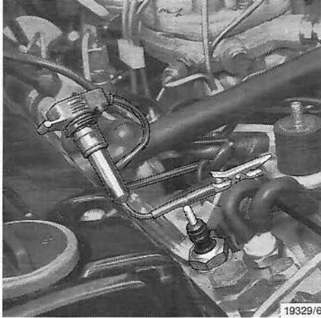
1. Prüf Widerstand 102 589 05 63 00 ALN 787-0171 an Kabelanschluß Kühlmittel-Temperaturfühler anschließen und an Masse legen.
