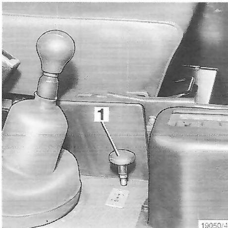
Entlüftungsventil öffnen, Schaltgriff (1) nach oben ziehen. Entlüftungsventil schließen. Schaltgriff nach unten drücken. Diesen Entlüftungsvorgang so lange wiederholen, bis blasenfreie Bremsflüssigkeit ausströmt. Staubkappe aufsetzen, Bremsflüssigkeit bis zur Maximal-Markierung auffüllen.
