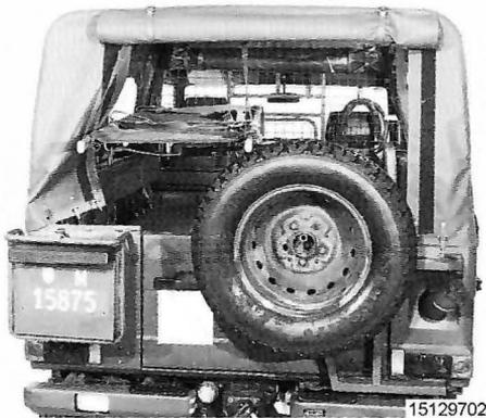
Tragbahren mit Halteriemen (Spanngurten auf den Fz) an der Verdeckstrebe befestigen.
