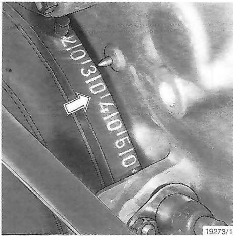
Der Zündzeitpunkt muß bei Leerlaufdrehzahl sowie bei 4500 /min.<sup>1</sup> ohne Unterdruck überprüft werden. Die Einstellung erfolgt bei 4500/min.<sup>1</sup>
