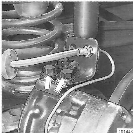
Befestigungsschrauben des Achsschenkelbolzens (Pfeil) lösen und abnehmen. HalteLasche mit Bremsleitung hochheben.
